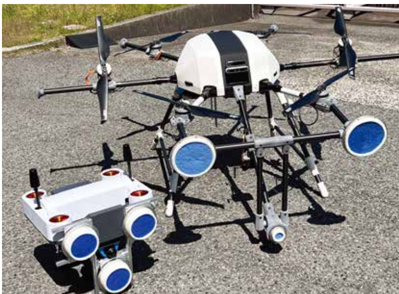
万博で世界に披露された、菱田技研工業の「壁面吸着親子ドローン」。吸着パッドを搭載し、垂直な壁面での安定した高所点検や穴あけなどの特殊作業を可能にする独自の先進技術です。
