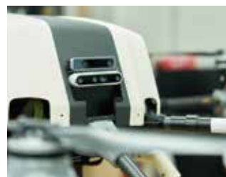
機体の前方に搭載された高性能カメラ。安全な高所点検作業を可能にする。
