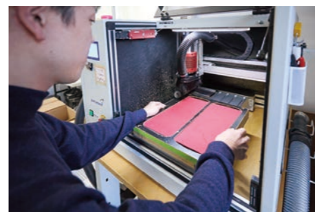
足底圧計測システムで計測したデータをもとに、CAD/CAMを用いてインソールを製作する切削機「ミーリングマシン」。
