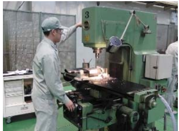
実習に使用する汎用フライス盤 (株)エツキ 社製
