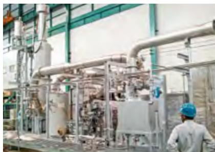
同社では、経済的かつ環境に配慮した「触媒酸化方式」による塩素系VOC処理装置を新たに開発。
