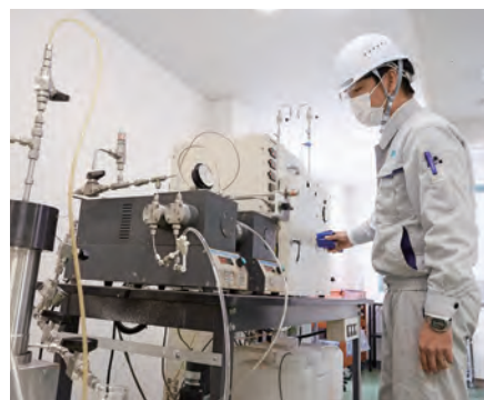
ナノ粒子の合成や無機粒子の造粒など、顧客に代わって超臨界技術装置による試験・試作を行っている。
