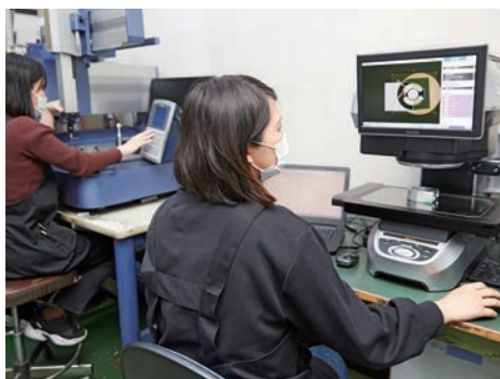
撮影した画像で寸法を確認する「画像測定機」。厳密な品質管理が行われている。
