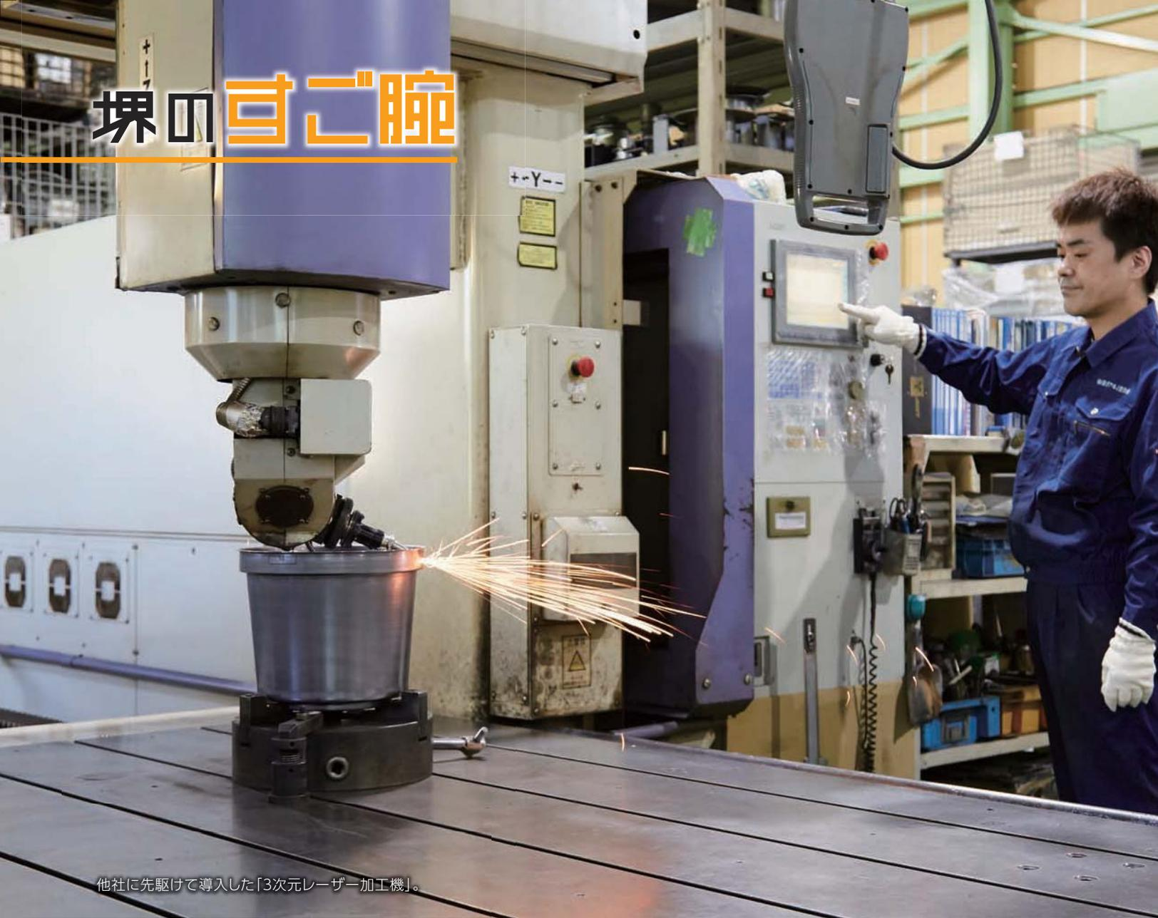
他社に先駆けて導入した「3次元レーザー加工機」。
