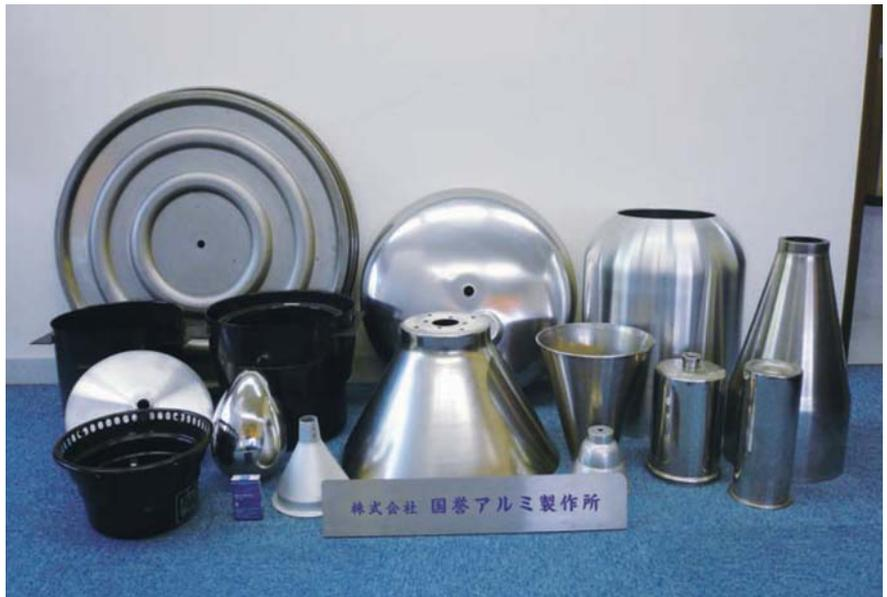
スピニングや三次元レーザー、プレス加工、溶接などの複合加工で製造された製品。
