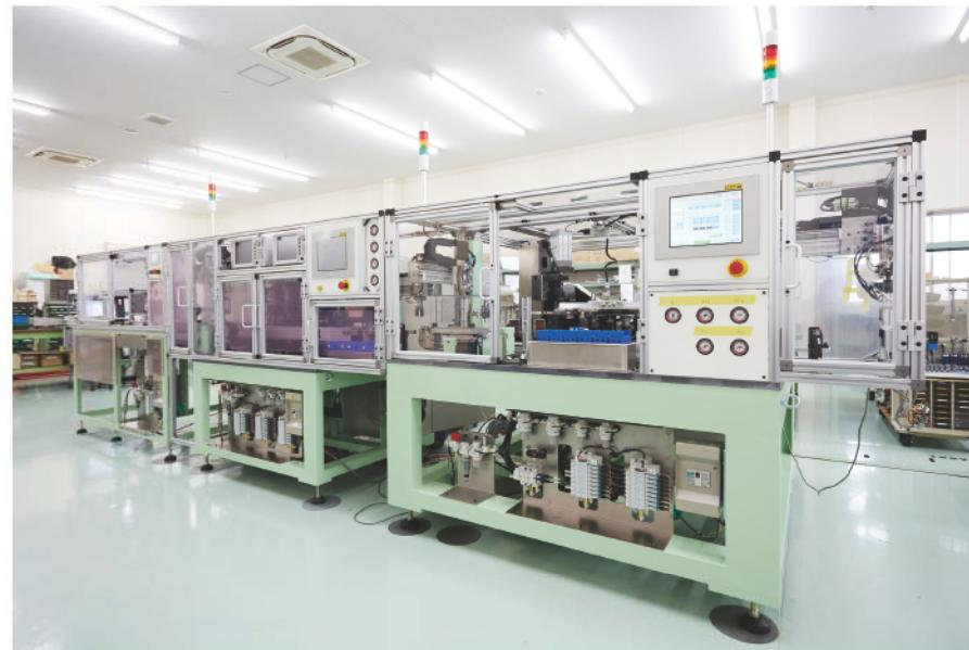
サンルーフの開閉用モーターの製造に使用されるバランサー
