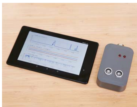
距離センサや振動センサなどのデータを手元のスマートフォンやタブレットに表示することが可能。離れていても現場の状況を把握できる「アルドボックス」。
