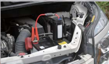
付属のクランプで直接バッテリーにつなげば、瞬間的に電流を流し充電します。
