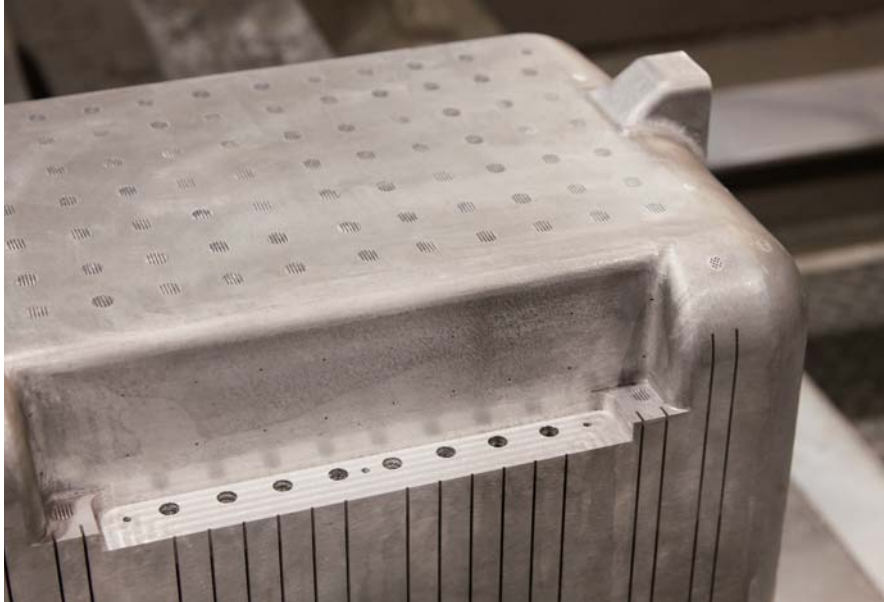
独自に開発された金型では、「スリット」がポイント。原料充填が困難な部に線条スリットが入っている。
