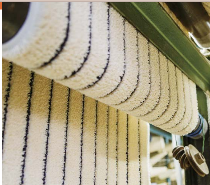
▲基布に何百本という針でバイルを植え付けていくタフト製法。
