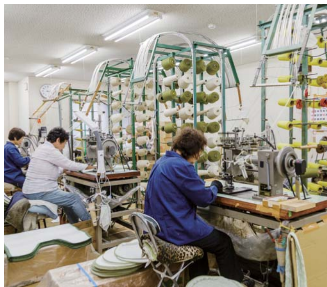
▲ミシンの踏み込みや基布を引く力の微妙な加減が求められる テーブルマシンによる植え込み
