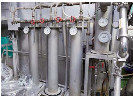
バッチ釜しかなかった時代から、自社開発した連続釜を使用。同社の高品質の豆腐づくりを支えてきた。
