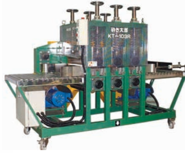
発注先に応じて加圧する強さを調整して出荷される粗碎機「砕き太郎」。今秋には、別素材と大型向けの粗碎機が登場予定。
