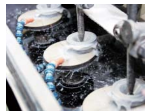
医療・測定機器に用いる異常分散ガラスの研磨工程
