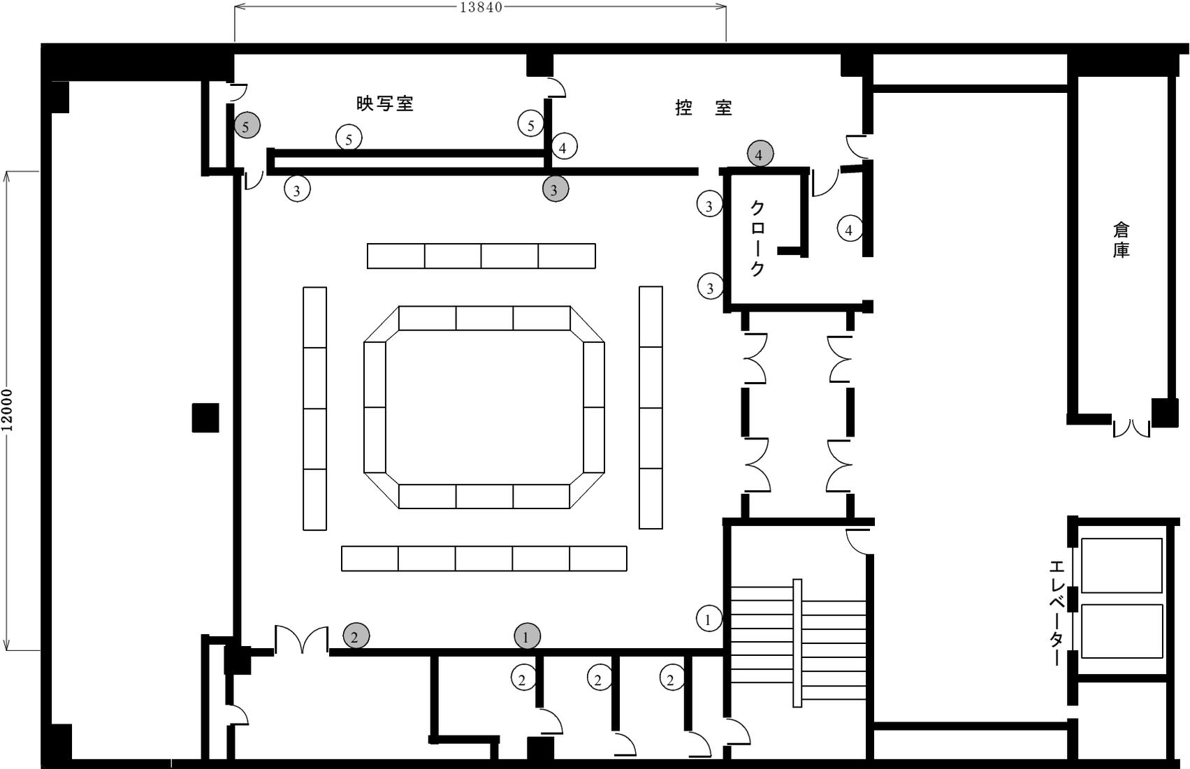
○ : コンセント (● : 抜け止めコンセント。数字は同一回路) 1.5kw × 5回路 = 7.5kw
