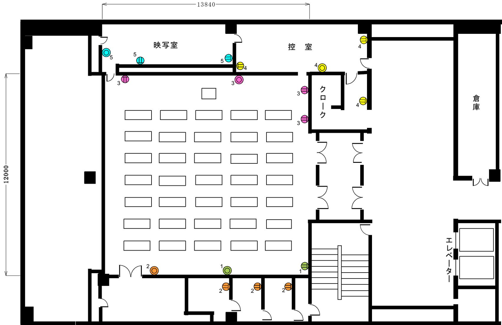
Ⓜ : コンセント ( Ⓞ : 抜け止めコンセント。数字は同一回路 )
