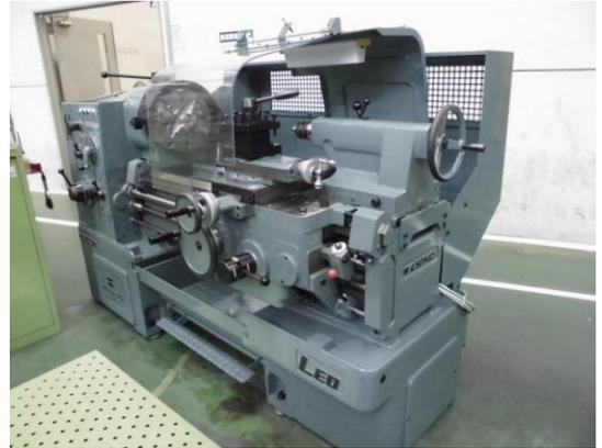
実習に使用する旋盤 (株)DMG森精機 LEO-80A
