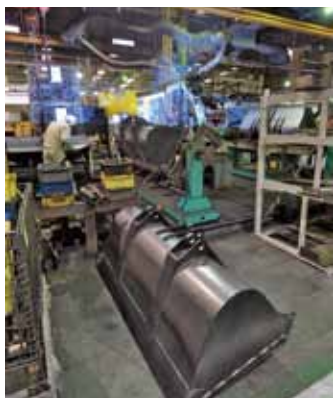
建設機械のホイールローダーのバケットも、10分の1ミリ単位での精度が求められる。
