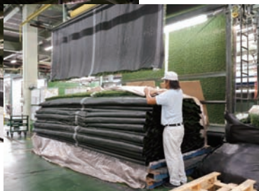
1,500本もの針でパイルを植え込むタフト機で人工芝も製造される。
