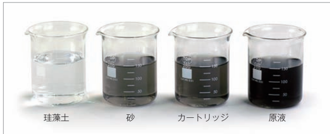
水に溶かした墨の粒子もろ過できる珪藻土ろ過方式。
