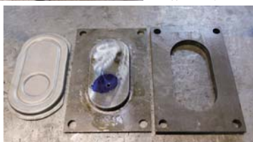
試作部品を製造するための簡易金型や簡易治工具は、職人一人ひとりの工夫によって作られる。
