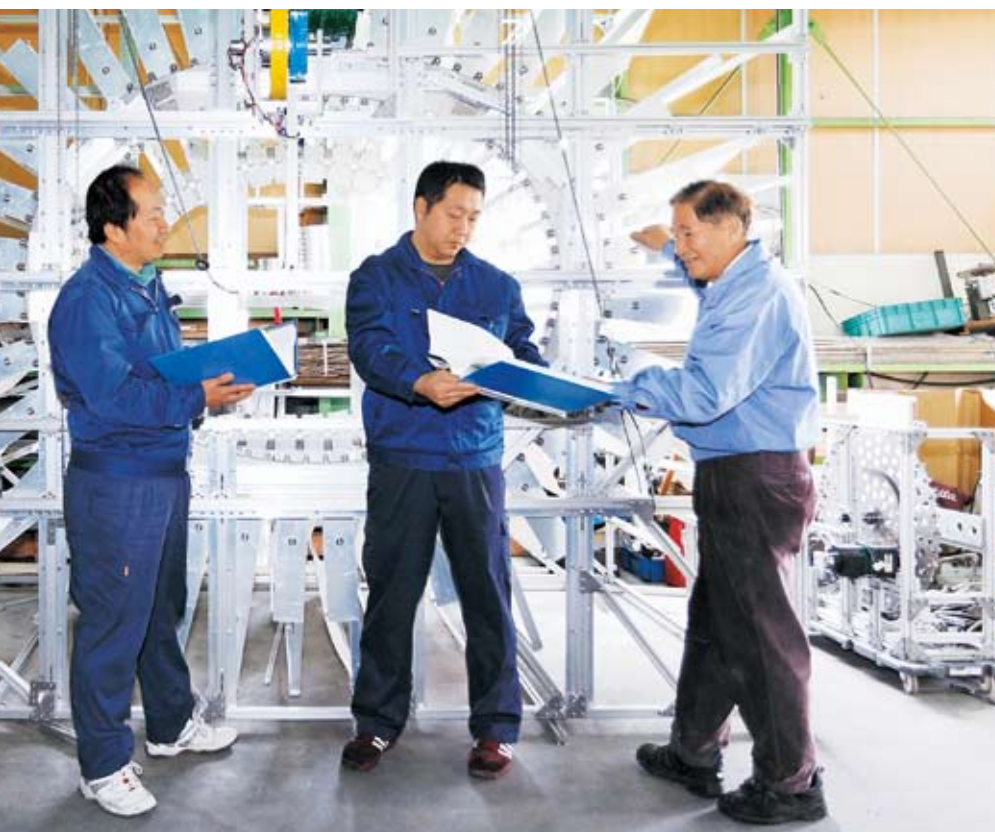
流水エネルギーを効率良く回収できる 「新型スクリュウ増速機」。
