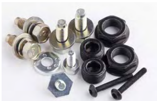
薬剤メーカーの協力のもと、同社オリジナルの3価クロメートの黄色を新開発(左上)。3価白との識別というニーズに応えているだけでなく、より耐食性を高めることに成功した。
