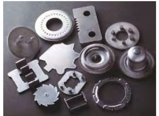
鍛造順送加工で従来のプレス加工品にない三次元形状の製品を製造できるのが同社のアピールポイント。
