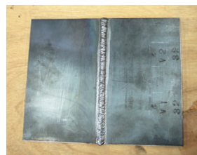
半自動炭酸ガスアーク溶接の試験片
